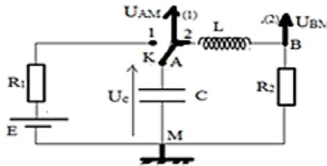
4.2.2 courbe 1 : U<sub>AM</sub>, tension aux bornes du condensateur. Initialement chargé, la tension à ses bornes est non nulle.
