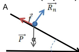
Système : {solide S}Bilan des forces extérieures :  $\vec{P}$   $\vec{R}_n$  et  $\vec{f}$
