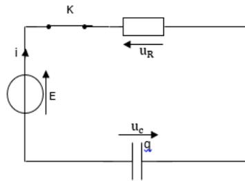
La loi d'additivité des tensions donne :  $u_R + u_c = E$  ; avec  $u_R = Ri$  ;  $q = C \times u_c$  et  $i = \frac{dq}{dt} = \frac{d(Cu_c)}{dt} = RC \frac{du_c}{dt}$
