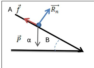
T.C.I :  $\vec{P} + \vec{R}_n + \vec{f} = m\vec{a}$  ; Sur x'x on a :  $mgsin\alpha - f = ma_x \Leftrightarrow a_x = gsin\alpha - \frac{f}{m}$
